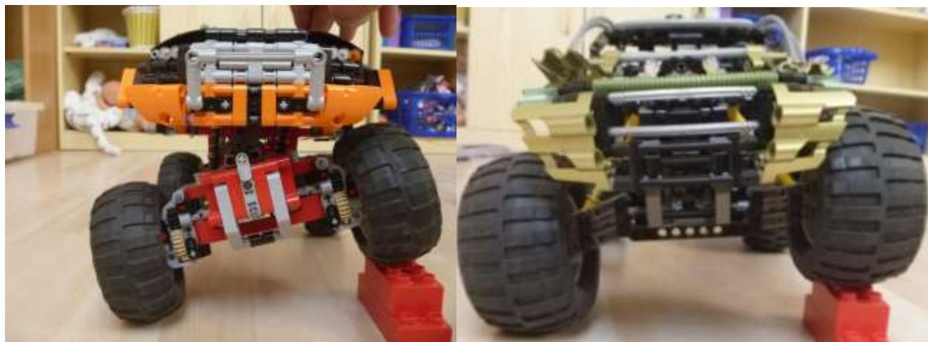
Slika 13: Primerjava toge preme in posamičnih obes na obeh lego vozilih
